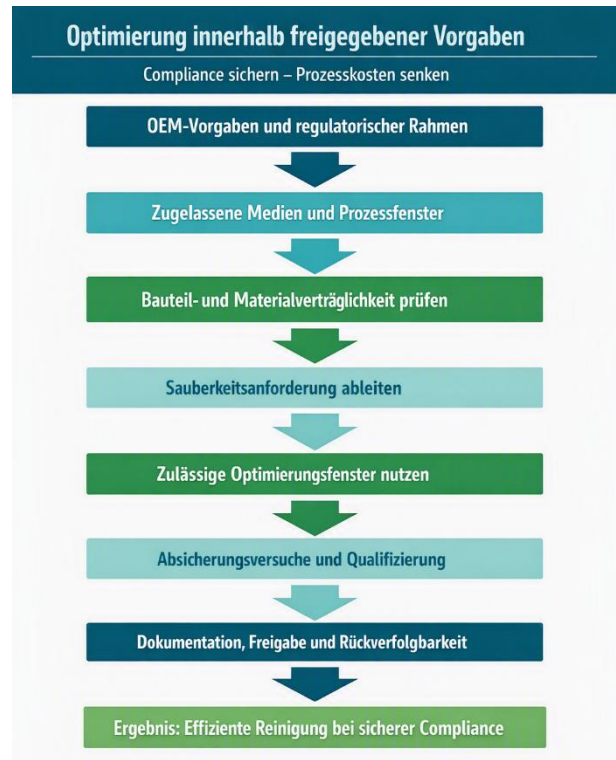
BILD 4: Umsetzung optimierter Reinigungsprozesse innerhalb von OEM- und regulatorischen Vorgaben.
