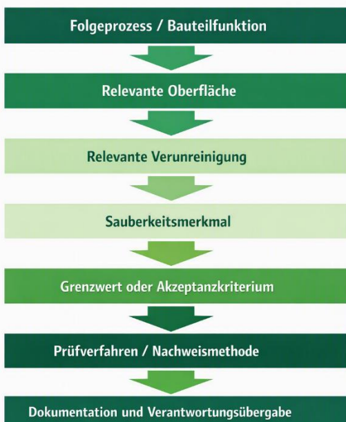
BILD 2: Struktureller Aufbau einer Sauberkeitsspezifikation nach DIN 4878-1, schematisch nach [18] und [19].
