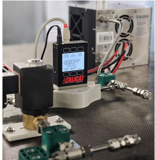
BILD 6. Wasserstoffversorgung mit Sicherheitseinrichtungen
