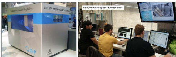
ERGEBNIS: Brennstoffflexible luftgelagerte Mikrogasturbine, Produktname: QIP Quality in Power, 20 Prototypen
