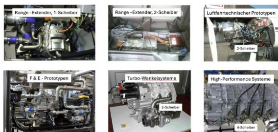
BILD 7. Wankel-GenSet 1 Scheiber und 2 Scheiber (links oben), 2-Scheiben Propellerantrieb mit Getriebe (rechts oben), Wankel-Prototypen (links unten), TURBO- 2 Scheiben-Wankelsystem (mitte unten), 4-Scheiber, Basis für den Turbo-Compound (rechts unten)
