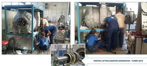
BILD 3. Erster Luftgelagerter Turbo-Gen Satz in einer Prototypenmaschine
