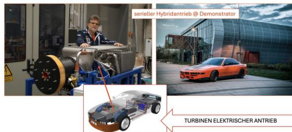
BILD 5. MGT-Einzelstück als Technologiedemonstrator für die Bauart einer hochkompakten MTiG-Technologie.
