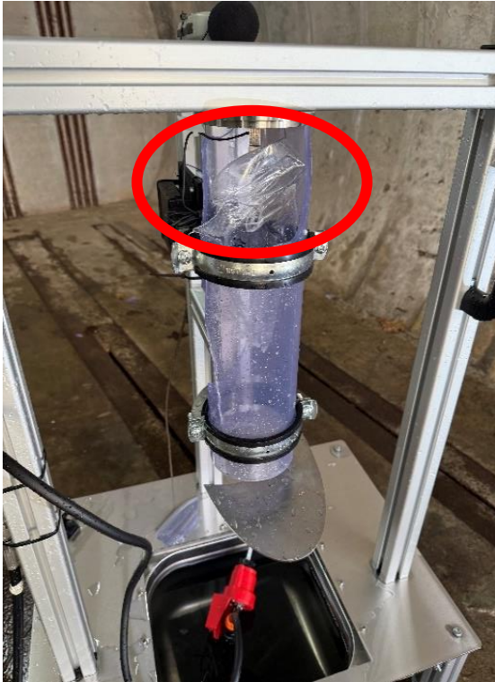
BILD 8. Bersttest mit der Flasche Nr. 1 vor der Modifikation
