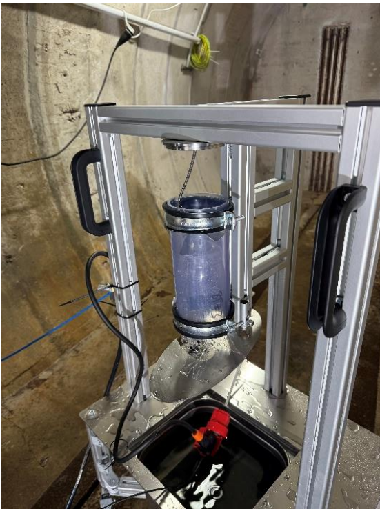
BILD 9. Bersttest mit der Flasche Nr. 2 nach der Modifikation
