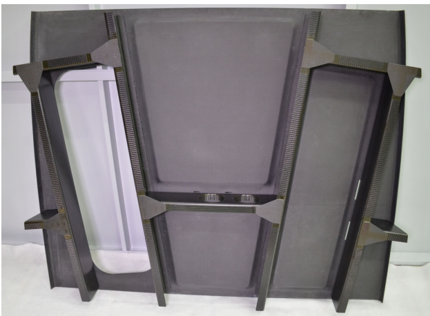
BILD 14. Finale Baugruppe des generischen Helikopter-Engine-Deck Strukturmodells.
