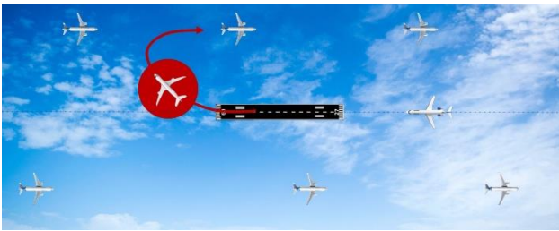
Abbildung 3: Prinzipbild eines Go-Around-Manövers eines Anflugs im Arrival-Peak eines Flughafens mit der Folge einer temporären Überlastung in der Downwind-Sequenz
