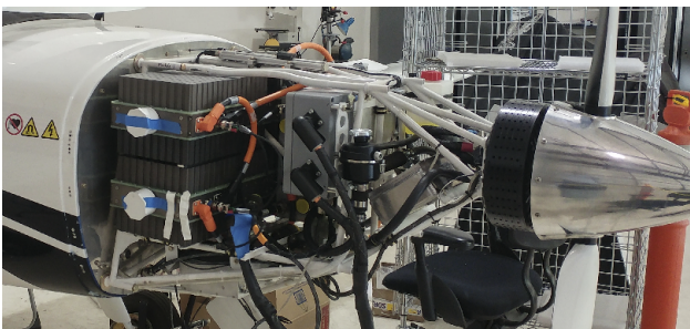
BILD 2. Vorderer Rumpf eines Elektroflugzeugs mit von Links: Zellmodulen, flüssiggekühltem Motorcontroller mit Leistungsstufe und flüssiggekühltem Motor
