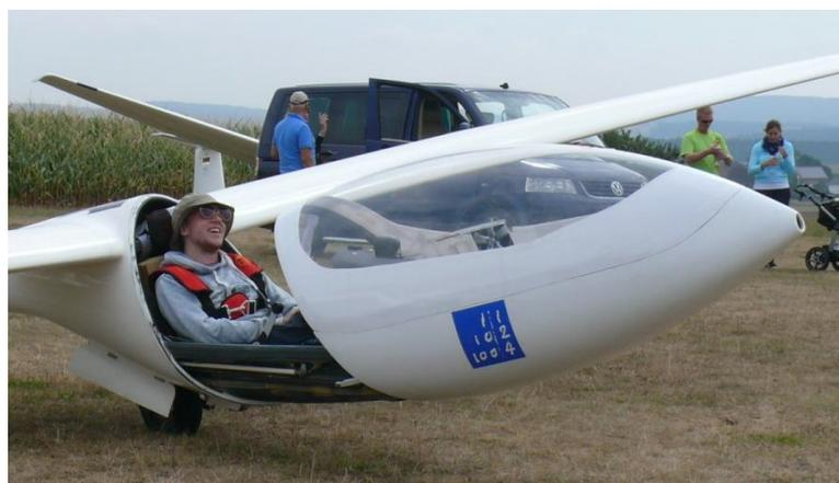
Abb. 2: Akaflieg Hannover AFH-24 mit aufschiebbarer Rumpfbauweise
