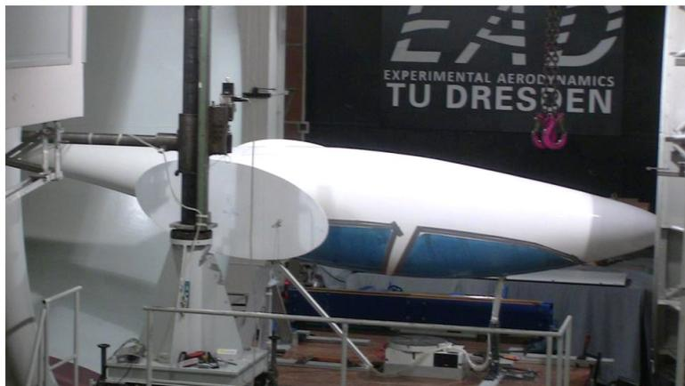
Abb. 8: Rumpfatrappe der D-B 11 im Windkanal (Anströmung von rechts)
