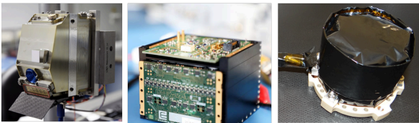
BILD 4: Wissenschaftliche Instrumente als Basis für die Nutzlasten der RAMSES CubeSat Mission. Links: MASCAM ; Source:[20], Mitte: LFR JuRA Quelle: [22], Rechts: MAS-MAG Quelle: [21]
