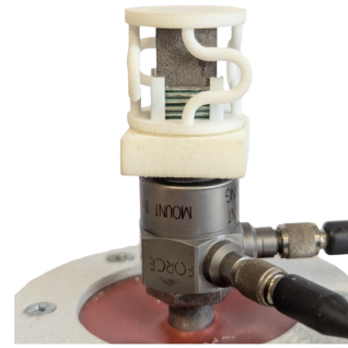
BILD 6. Messaufbau zur Parameterbestimmung der Resonatoren.
