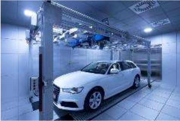
BILD 8. Indoor Air Test Center (IATC) mit Nachbildung solaren Wärmeeintrags
