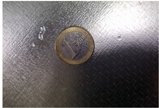
BILD 19. Oberflächenfehler der geschlitzten Oberfläche (versetzten Anordnung)
