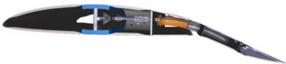
Abbildung 1: Flügelquerschnitt mit ausgefahrener Wortmannklappe
