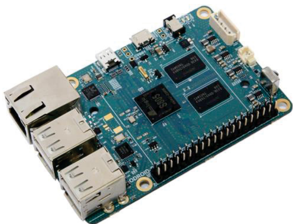
BILD 1. Einplatinenrechner Odroid C1 [3]
