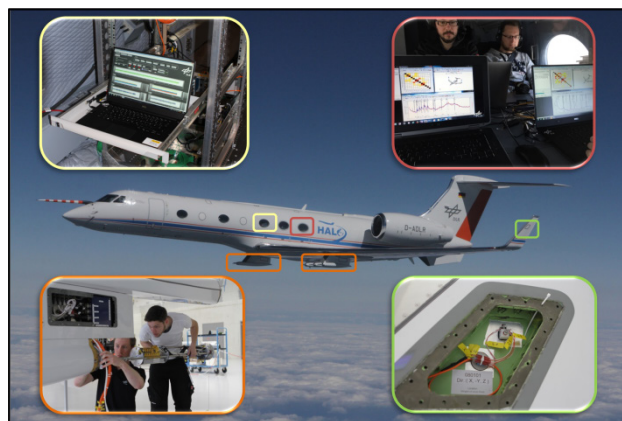
BILD 3. Mess- und Analyseketten im HALO vom Beschleunigungssensor (u.r.) über die NI-Messanlagen (u.l.) und dem Datenerfassungs-PC (o.l.) in der Kabine bis zu den Analyse-PCs für die Online Modalanalyse (o.r.)
