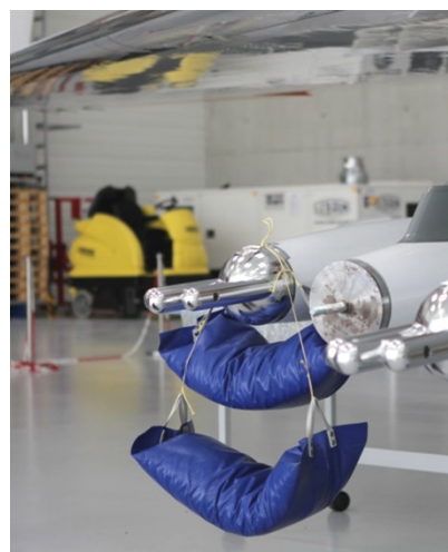
BILD 16. Kalibrierung der DMS von einem PMS-Carrier
