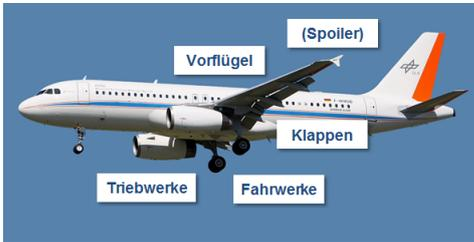
BILD 4. Haupt-Schallquellen am Flugzeug [8]
