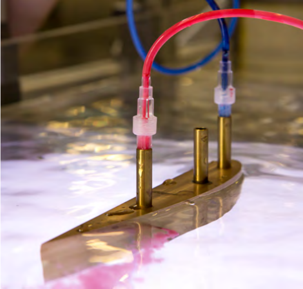
BILD 8. Einleitung der Farbe direkt in den Versuchskörper NACA 4415.
