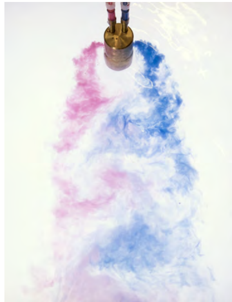
BILD 7. Kármánsche Wirbelstraße im Showbereich des MFWK bei Re \approx 2800 .
