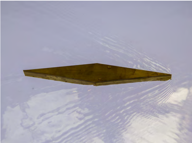
BILD 2. Ein Rhombus bei schießendem Wasser im Showbereich des MFWK bei Fr \approx 4,2 .
