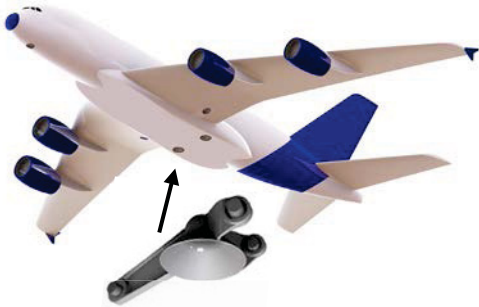
BILD 11. Flugzeugseitig integrierte Schnittstelle zur Kopplung mit einem Bodenfahrwerk [8]
