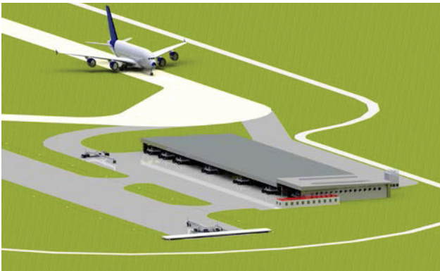
BILD 14. Flugzeug auf einem Bodenfahrwerk und freie Bodenfahrwerke mit Fahrwerks-Halle
