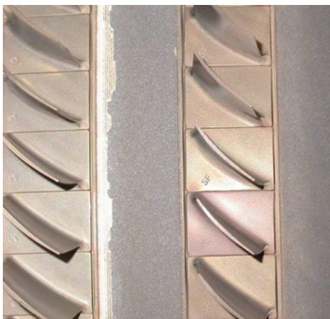
BILD 11. Verschleißbeispiel einer Verdichtertrommeleinlaufschicht
