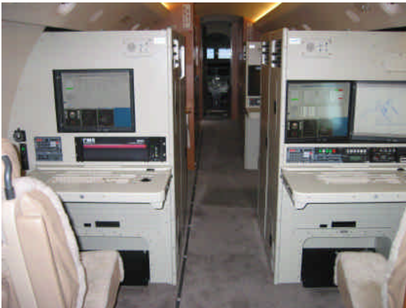
Ein Blick in das „Innenleben“: Arbeitsplätze für die Vermessung von Flug-Sicherungsanlagen, insbesondere Instrumenten-Landesysteme
