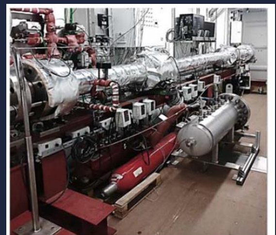
Hochdruck-Stoßrohr im Energielabor der TU Berlin
