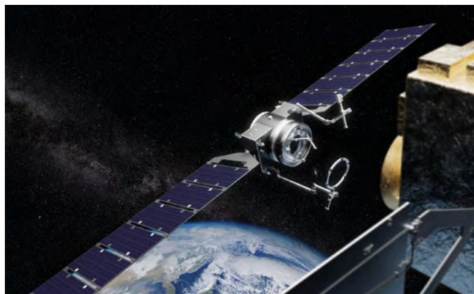
RISE ist eine kommerzielle Mission unter der Leitung von D-Orbit, die das Andocken und Kontrollieren eines geostationären Client-Satelliten zur Verlängerung seiner Mission demonstrieren soll
