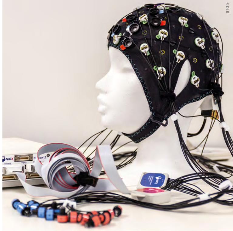
Neurophysiologisches Messequipment im DLR: Elektroenzephalographie und funktionelle Nahinfrarotspektroskopie erfassen die Gehirnaktivität
