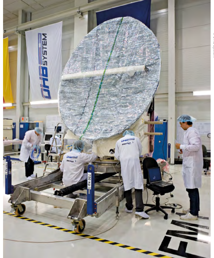
Abschließende Integrationsarbeiten an SAR-Lupe in Bremen für die Umwelttestkampagne und anschließende Integration in die Rakete
