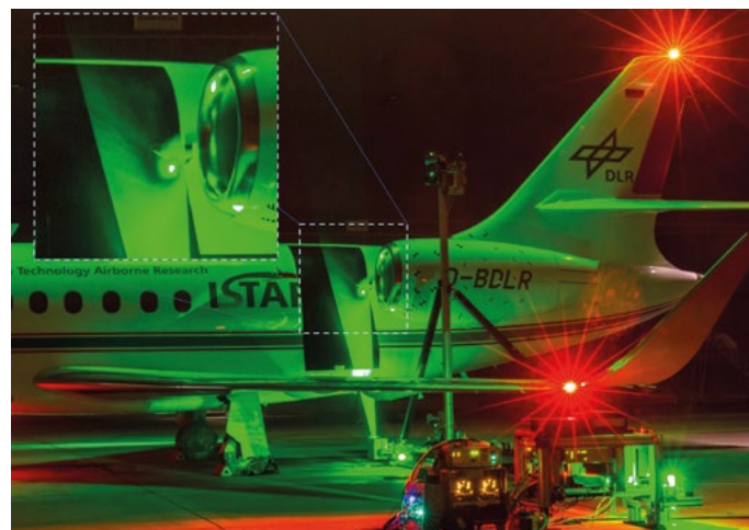
Triebwerksbodenlauf mit Einlaufwirbelvermessung mittels PIV (kleines Bild: Detail des Wirbels)
