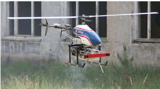
BILD 1: ARTIS-Hubschrauber mit Stereokamera. Rotordurchmesser 1,9 m, Abflugmasse bis 15 kg, Nutzlast 6 kg. Der Hubschrauber ist mit GPS/INS-Navigation, einem Flugsteuerrechner und einem Bildverarbeitungsrechner ausgestattet.
