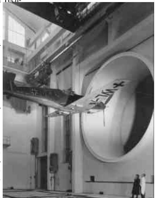
Der große Windkanal A3 der alten LFA mit einer 109 in der Messstrecke
