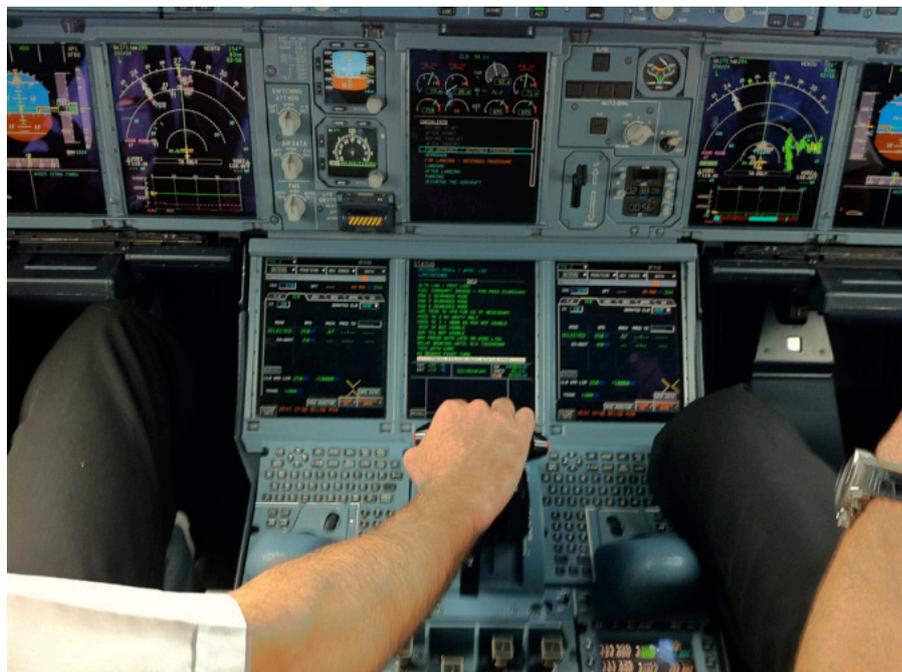
Bild 4: Zentrales Warn-, Anzeige- und Kontrollgerät A380 (ECAM) mit Fehlermeldungen und Handlungsanweisungen
